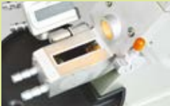
System oświetlenia górnego do próbek standardowych.
