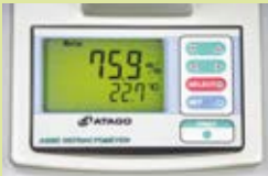
Pomiar %Brix z kompensacją temperatury.
