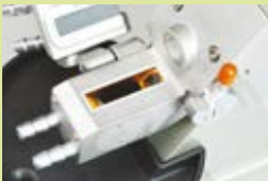
System oświetlenia dolnego do próbek trudnych.
